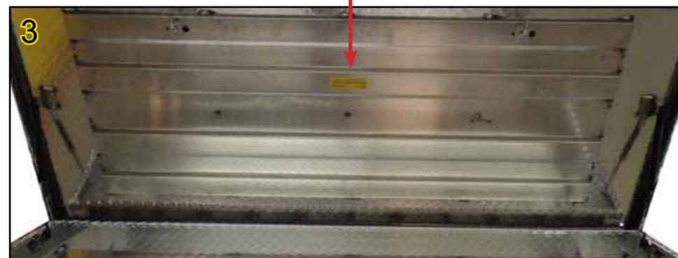
CYLINDER COVER MUST BE IN PLACE FOR NORMAL OPERATION.
